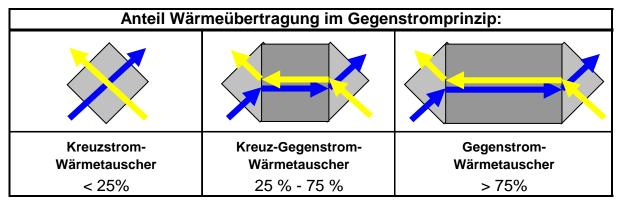
Der häufig verbreitete Typ des Kreuz-Gegenstromwärmetauschers ist bei den Defaultwerten derzeit leider nicht extra angeführt. Da das Temperaturverhältnis eines Kreuz-Gegenstromwärmetauscher aber sehr nahe beim Gegenstromwärmetauscher liegt, und alle Lüftungsgeräte nach EN 13141-7 in der Geräteliste von komfortlüftung.at über 70% liegen, könnte aus rein fachlicher Sicht auch für Kreuzgegenstromwärmetauscher der Defaultwert von 70% für das fortluftseitige Temperaturverhältnis angesetzt werden.
